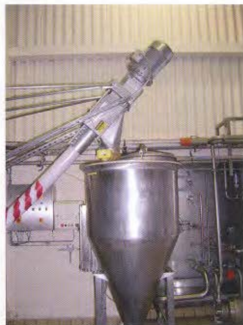
Afb 3 Een spiraaltransporteur brengt de grondstoffen naar een blender
