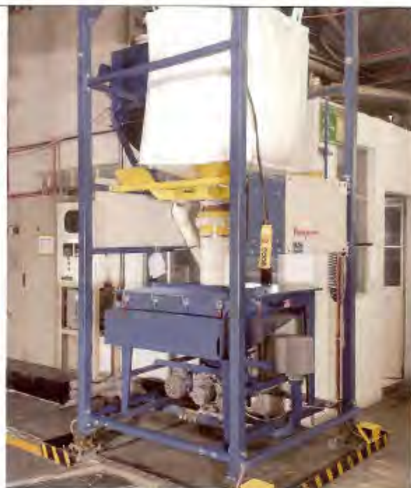
Oplex installierte zum Zwecke der Qualitäts- und Produktivitätsverbesserung seines PVC eine PVC-Mischanlage der Serie BFC-Bulk-Bag-Entleerung.
