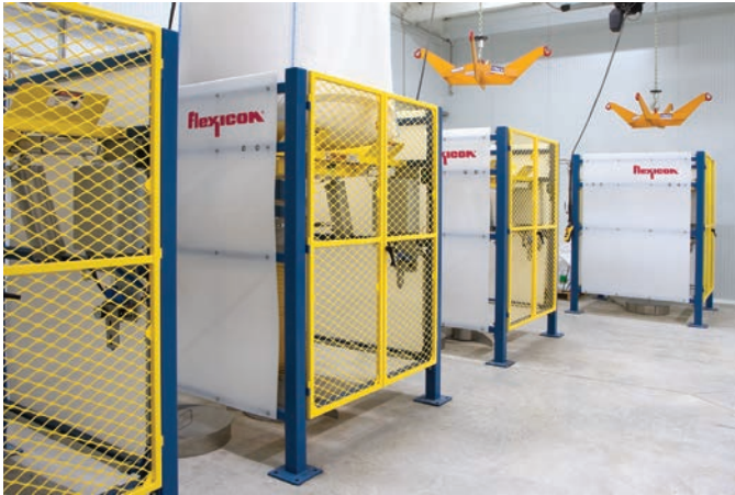
Siete descargadores de Big Bags modelo BFH-C-X alimentan a envasadoras 70 toneladas al día a la planta inferior. Un polipasto eléctrico colocado encima de cada descargador levanta el Big Bag y lo sitúa encima de la estructura del descargador
