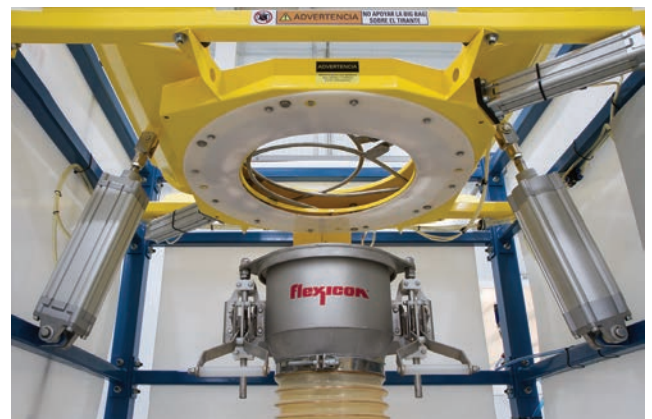
Siete descargadores de Big Bags modelo BFH-C-X alimentan a envasadoras 70 toneladas al día a la planta inferior. Un polipasto eléctrico colocado encima de cada descargador levanta el Big Bag y lo sitúa encima de la estructura del descargador
