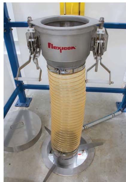
El anillo de cierre Spout-Lock crea una conexión estanca entre el lado limpio de la manga del Big Bag y el lado limpio del tubo telescópico Tele-Tube, que eleva el anillo de sujeción para conectarse con la manga del Big Bag, y posteriormente baja, aplicando una tensión continua para ayudar la descarga de material en la envasadora en el piso de abajo
