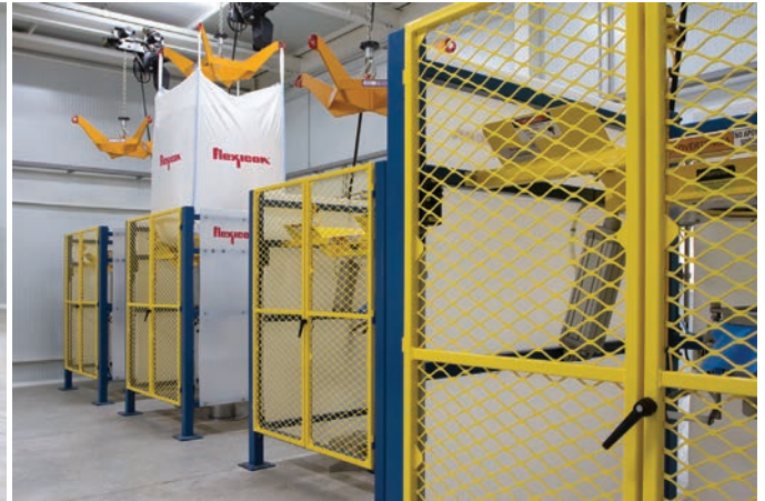
Siete descargadores de Big Bags modelo BFH-C-X alimentan a envasadoras 70 toneladas al día a la planta inferior. Un polipasto eléctrico colocado encima de cada descargador levanta el Big Bag y lo sitúa encima de la estructura del descargador
