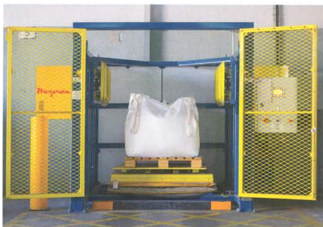
Die Einheit befindet sich in einem frei stehenden Stützrahmen mit zwei Hydraulikkolben sowie einer Scherenhebebühne.
