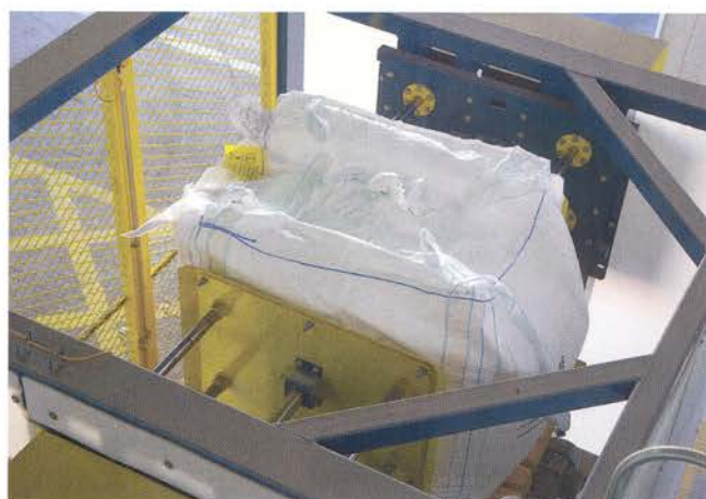
Hydraulikkolben mit speziell geformten Endplatten drücken auf gegenüberliegende Seiten des Bags, um verfestigtes Pulver zu lockern.
