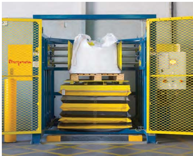
Afb. 1 De Block-Buster kan bigbags op diverse hoogten masseren
