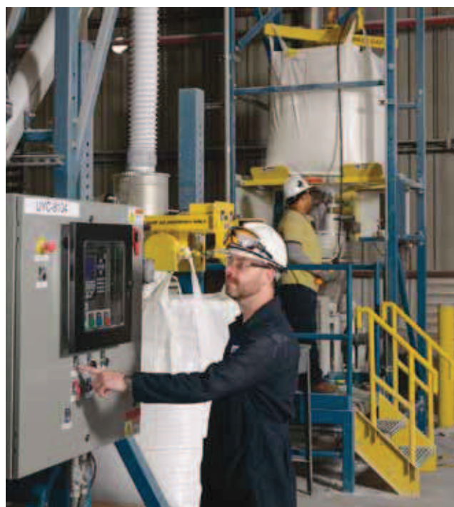
Au premier plan, un opérateur lance un cycle de remplissage de sacs d'expédition en vrac tandis qu'à l'arrière-plan, l'autre opérateur charge un sac sur le châssis du déchargeur à l'aide du palan électrique et du chariot.
