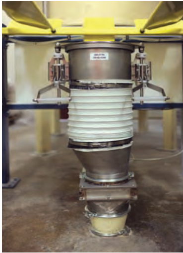
Die Zutaten werden über die Schwerkraft den Verarbeitungslinien zugeführt. Ingredients are gravity fed into the processing lines.
